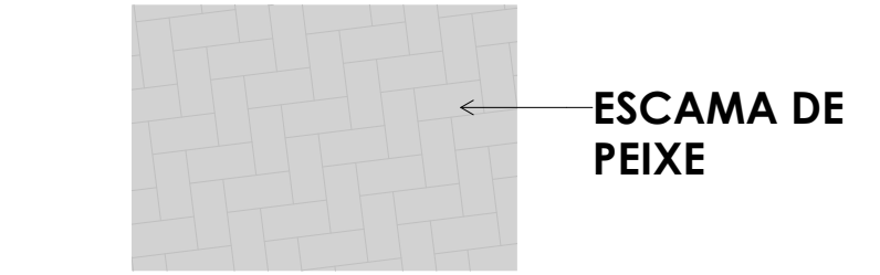
3 DETALHAMENTO-PAGINAÇÃO INTERTRAVADO(CONVENCIONAL) 1 : 25
